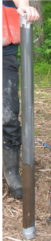
Photographie d'une carotte de sédiments démontrant qu'une couche importante de sédiments riche en matière minérale provenant des haldes de résidus miniers (horizon supérieur gris) a été déposée au cours des dernières décennies dans l'étang Stater.
